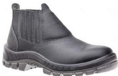
Bota de segurança confeccionada em couro vaqueta com curtimento atravessado, 1,8/2,0 mm linhas de espessura, fechamento em elástico, forração em tecido não tecido transpirável, palmilha de montagem em poliéster resinado fixada/costurada junto ao cabedal (processo Strobel), solado em PU Bidensidade bicolor com sistema de absorção de impacto, injetado diretamente ao cabedal. Numeração disponível 33 a 47. Opcionais: biqueira de aço, PVC ou composite. Palmilha de aço.
