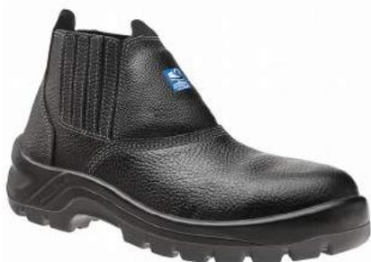
Bota de segurança confeccionada em couro com curtimento atravessado, 1,8/2,0 mm linhas de espessura, fechamento em elástico, forração em tecido não tecido transpirável, palmilha de montagem em tanino dublada ou têxtil resistente a perfuração fixada/costurada junto ao cabedal (processo Strobel), biqueira de composite, solado em PU Bidensidade bicolor com sistema de absorção de impacto, injetado diretamente ao cabedal.
